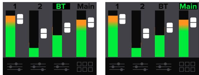
Um den Pegel zu ändern, drücken Sie den Encoder, wenn der gewünschte Kanal leuchtet. Im Beispiel unten sehen Sie, wie der Fader von Kanal 2 auf die -14 dB-Marke bewegt wurde. Sobald Sie den gewünschten Pegel eingestellt haben, drücken Sie erneut den Encoder, um zum Mixer-Bildschirm zurückzukehren.
